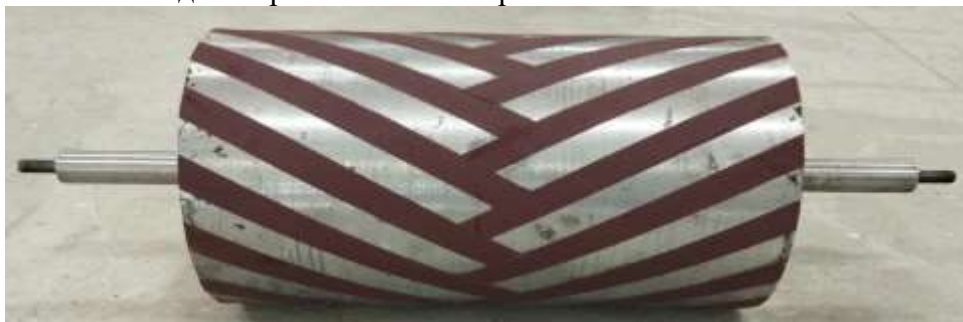
Рисунок 5. Усовершенствованная конструкция барабана для шлифования кожи и меха (ИМСС АН РУз) [16]
